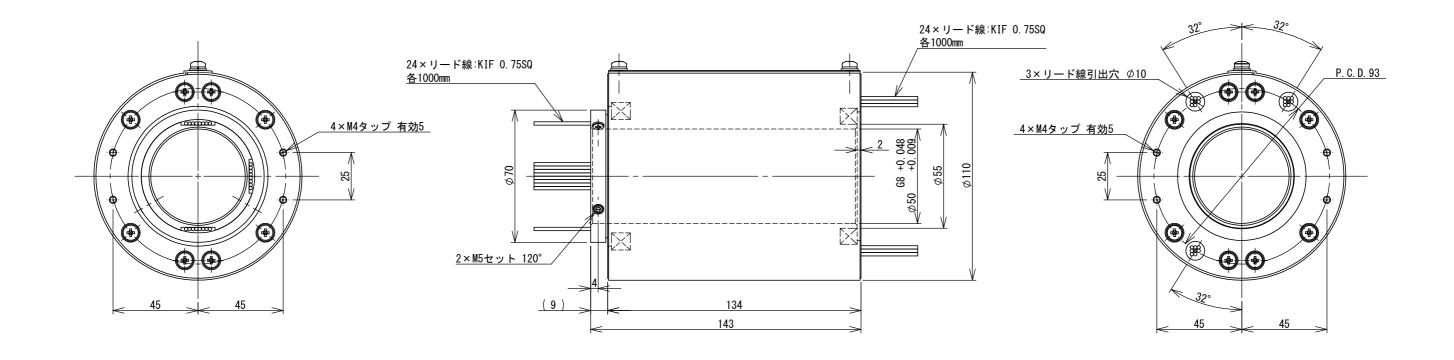
※回転寿命6000万回転以上 ※1000万回転毎にカバーを開放し、磨耗粉除去のメンテナンスが必要です。
